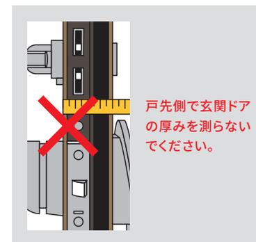
玄関ドアの戸厚は必ず吊元側やドアの下側で測ってください。戸先側には部品が付いているため正確に測ることができません。
